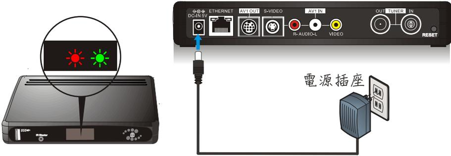
※如發現紅燈無法亮起則表示您的網路設備不支援隨插即用功能，須依後頁章節 ” 網路連線之設定 ” 中，以手動方式設定影音駭客變更網際網路連線設定，或使用寬頻分享器(Router)設定 DMZ 或虛擬伺服器(Virtual Server)之功能
