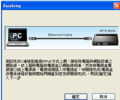
連線型態為 PPPoE 方式上網，請移除電腦與網路設備之網路線，依圖將電腦與電視盒以網路線相連，然後將電視盒電源接口插上電源線，電源插頭插入市電插座，待電視盒開機完成(供電後綠燈狀態將開始閃爍直到恆亮即開機完成)，再按[確定]將出現如下圖 PPPoE 設定頁面
