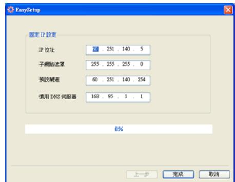
輸入設定內容後按下[完成]結束設定。之後拔除電視盒之網路線與電源線，將欲安裝電視盒之網路接口透過網路線連接到電視盒上後再插入電源線，待開機完成紅綠兩燈恆亮後，即設定完成。
